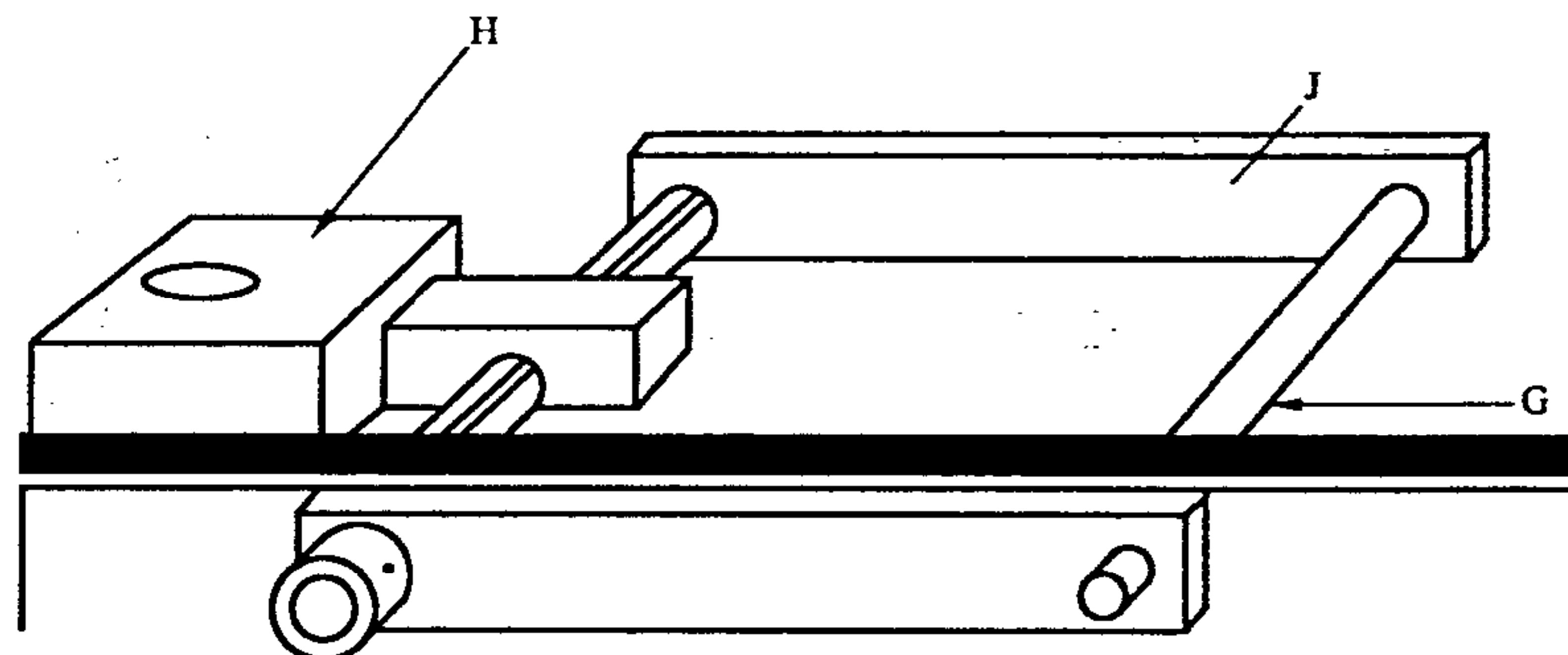
注: G 杆能插入矮粗鞋跟钻的孔中,或当较细的鞋跟进行试验时,能移去 G 杆换上图 2 所示的设备。
